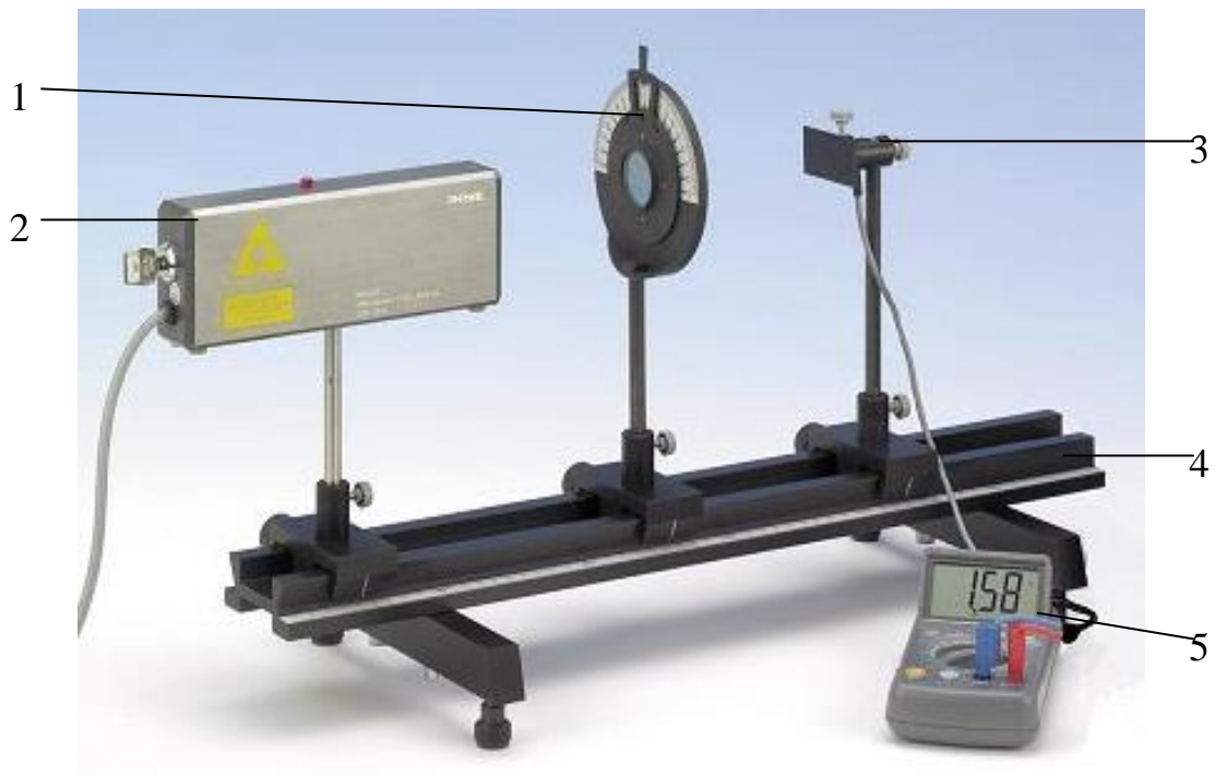
Рис. 6. Експериментальна установка для перевірки закону Малюса: 1 - поляризаційний фільтр, 2 – лазер, 3 – фотоелемент, 4 - оптична лава, 5 - цифровий мультиметр.
