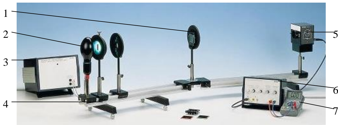
Рис. 7. Експериментальна установка для визначення сталої Планка: 1 – тримач для лінзи, 2 - ртутна лампа, 3 - джерело струму, 4 - оптична лава, 5 - фотоелемент з кожухом, 6 - універсальний підсилювач, 7 - цифровий мультиметр.
