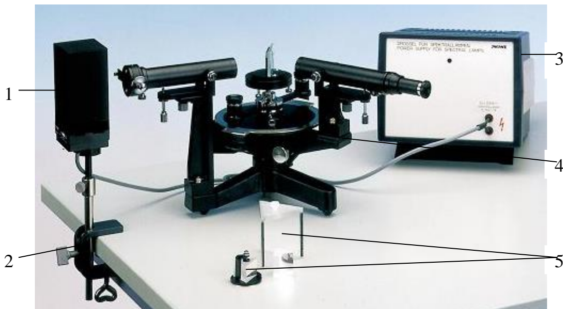
Рис. 3. Експериментальна установка: 1 - спектральна лампа, 2 - настільний затискач, 3 - джерело струму, 4 - спектрометр-гоніометр з ноніусом, 5 - призми.
