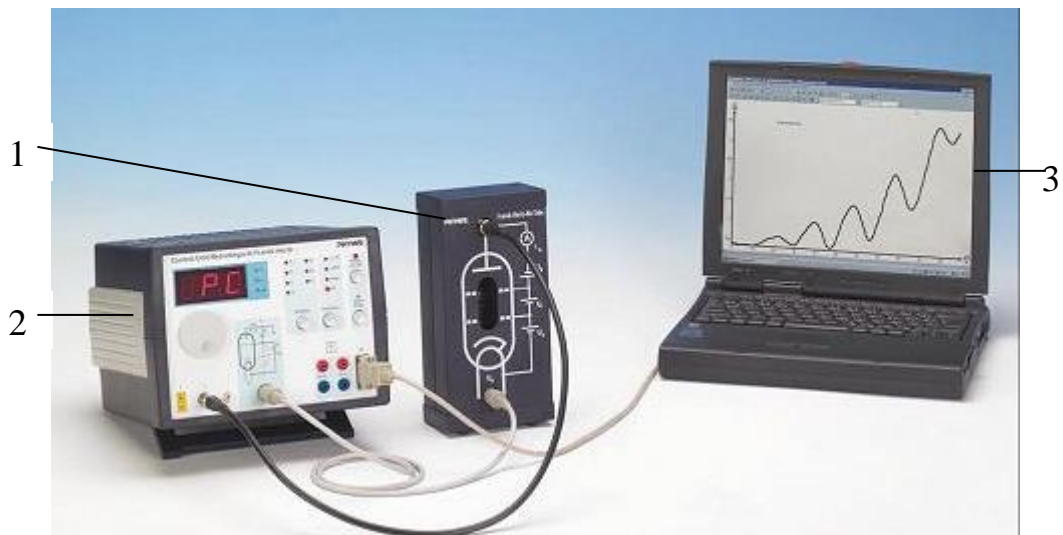
Рис. 9. Експеримент Франка-Герца з неоновною трубкою: 1 - неоновна трубка Франка-Герца з кожухом, 2 - джерело струму, 3 - система «Кобра 3».
