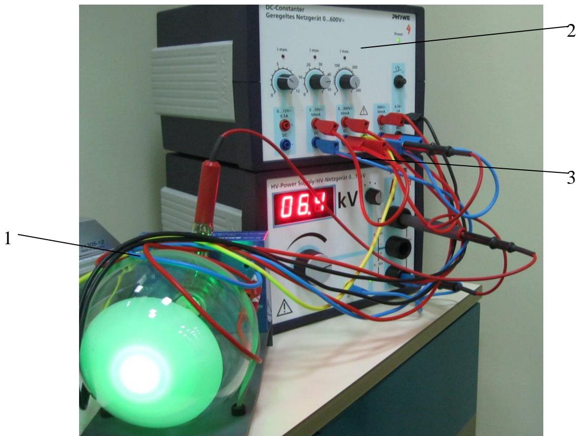
Рис. 1. Установка для спостереження дифракції електронів: 1 - електронно-дифракційна трубка з кріпленням, 2 - джерело постійного струму 0...600 В, 3 - високовольтне джерело струму 0...10 кВ.
