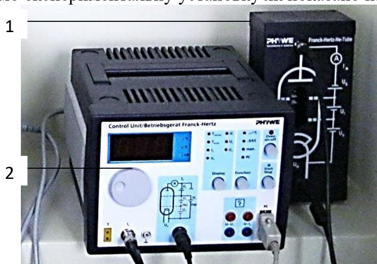
Рис. 3. Експеримент Франка-Герца з неоновою трубкою: 1 – неонова трубка з кожухом, 2 – джерело струму
