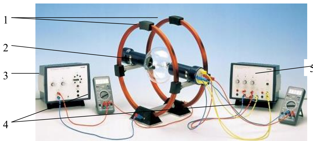
Рисунок 1. Питомий заряд електрона: 1 - котушки Гельмгольца, 2 - вузька електронно-променева трубка, 3 - універсальне джерело струму, 4 - цифровий мультиметр, 5 - джерело постійного струму 0...600 В.
