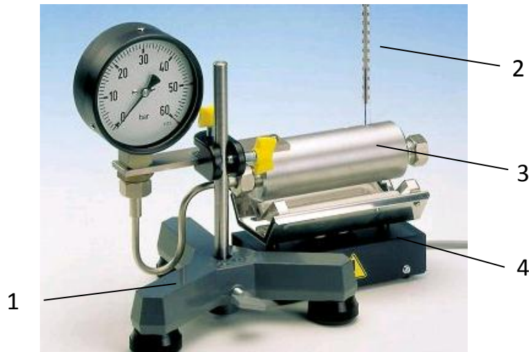
Рис. 1. Експериментальна установка для вимірювання температурної залежності тиску водяної пари: 1 - тринога, 2 - лабораторний термометр діапазоном -10..+250^{\circ}\text{C} , 3 - пристрій для отримання пари високого тиску, 4 - нагрівник.
