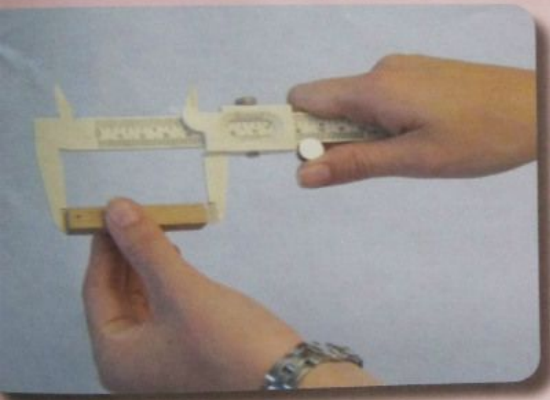
Мал. 6. Вимірювання довжини бруска
