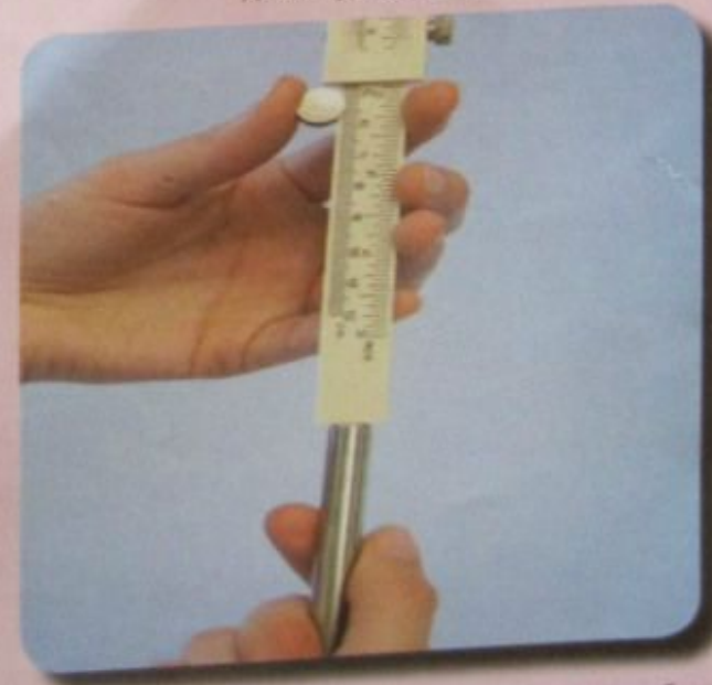
Мал. 9. Вимірювання глибини металевої трубки
