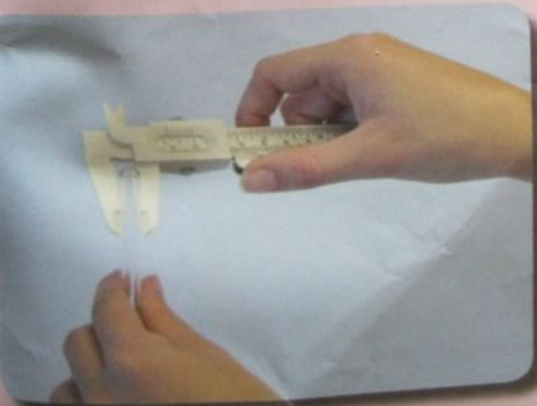
Мал. 8. Вимірювання зовнішнього діаметра капіляра
